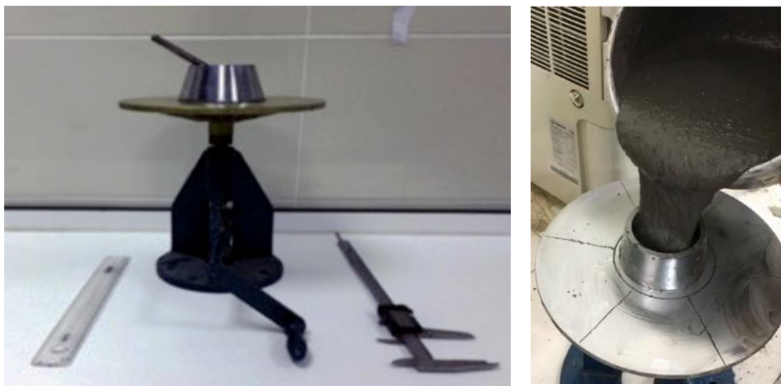
Рис. 8. Усеченный миниконус для определения расплыва бетонной смеси
