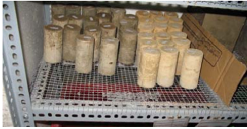
Hình 3. Đúc mẫu và bảo dưỡng
